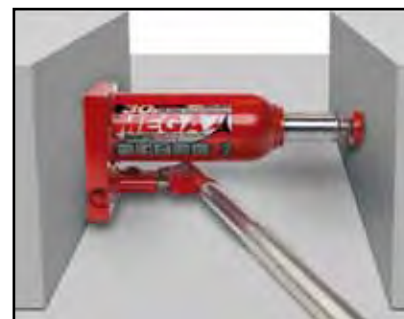
Samtliga domkrafter går att använda horisontellt så länge pumpen vänds nedåt.
